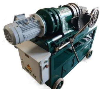
Máquina tipo RO32 para roscar barras en un solo paso.
