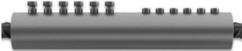
Solo requieren 20 centímetros de barra saliendo del concreto en 1 1/4" y 8 centímetros 1/2", los empalmes de tornillo aseguran como las otras referencias de empalmes la transmisión completa de esfuerzos entre las barras.
